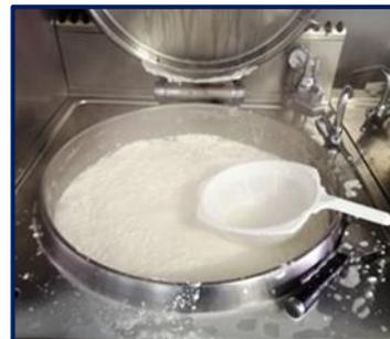
Fig. 15 Recolha dos flocos de caseína e proteínas do soro
