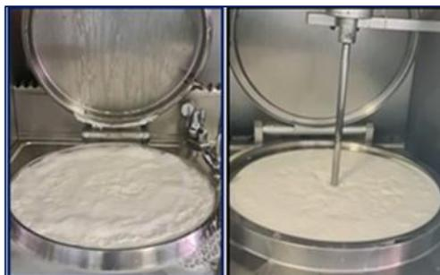
Fig. 14 Marmitas com a formação dos flocos de coalho prontos para recolha
