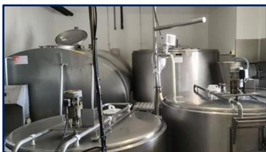
Fig. 10 Conservação do leite cru recepcionado nas unidades de transformação
