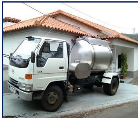
Fig. 9 Veículo de recolha e transporte de leite
